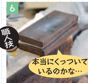
圧力を加えた素材に、ふたたび水と熱を加えて厚みを戻します。
