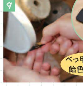
仕上げのツヤ出しのために布バフで磨きをかけます。
